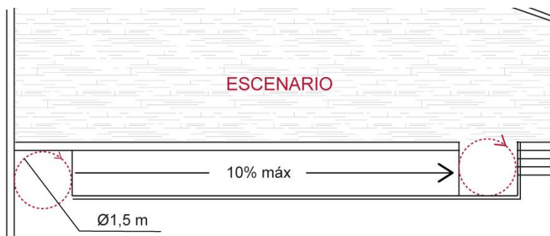
Fig. 103 (arriba) y 104 (abajo): Escenario accesible por medio de rampa paralela al escenario. Estos casos se exigen de utilizar barandas, requiriéndose solo una protección de 0,1m de alto.
