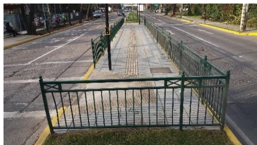
Fig. 13: Mediana de ancho inferior a 6 metros donde existe circulación peatonal a lo largo de ésta.
