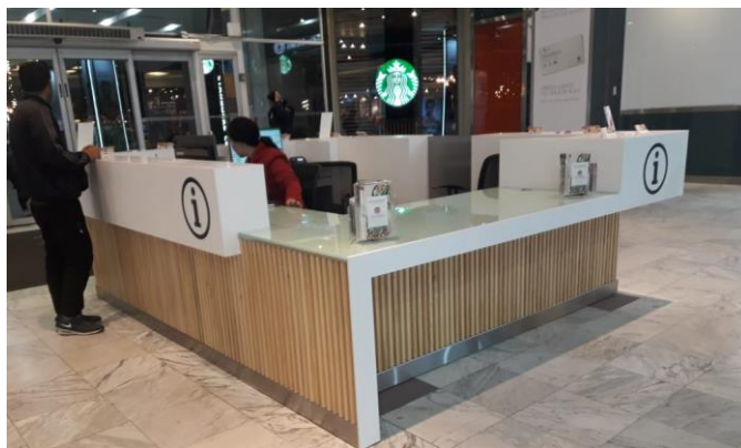
Fig. 71: Los mesones de atención deben considerar una altura, ancho y profundidad determinada Foto 66: Mesón de atención accesible
