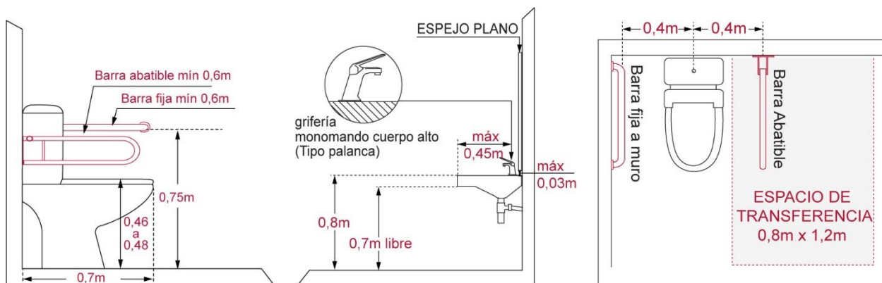
Fig. 123 (izq): Requisitos para instalación de inodoro.
