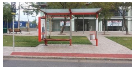
Fig. 28: Paradero a desnivel con la vereda y conectado a través de una rampa con la ruta accesible.
